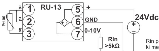
Rin predstavlja vhodno upornost instrumenta (npr PLC), ki meri izhodno napetost pretvornika 0 .. 10V
