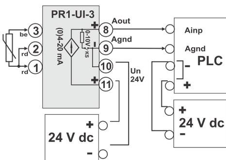
Pretvornik in PLC napajana z istim napajalnikom
