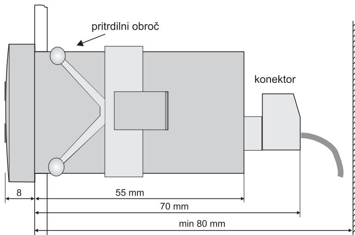
Če termostat vgradimo v dozo DPD-01(pribor), lahko dozo z vgrajenim termostatom enostavno pritrdimo na steno.
